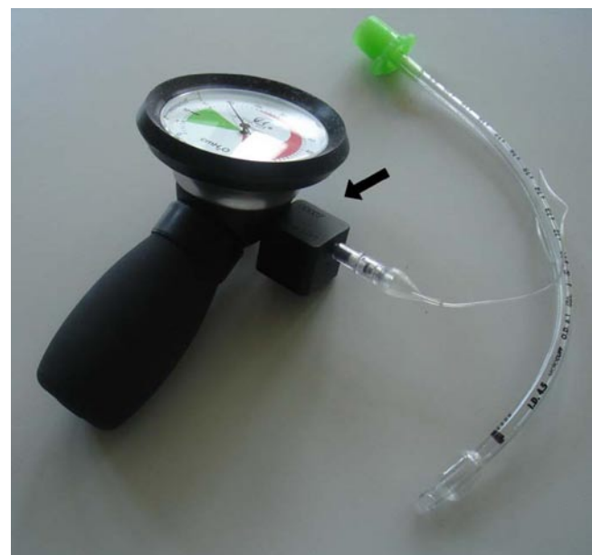
Abb. 1 ▶ Getestetes Überdruckventil (Pfeil)
