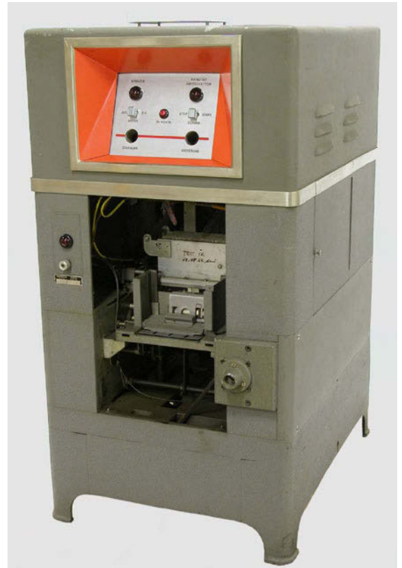
Abb. 8 Rechenlocher M9 für die Schweizer Remington Rand (Lochkarteneinheit), © Museum für Kommunikation, Bern
