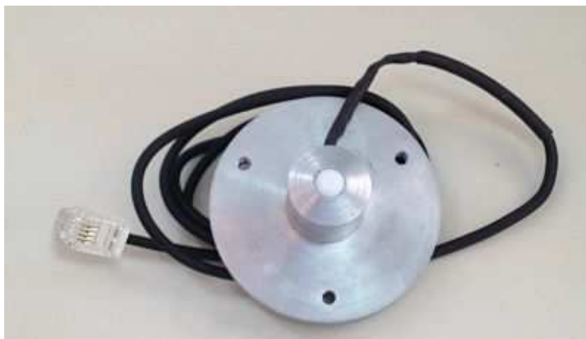
Figura 2: Foto del Piranómetro fotovoltaico construido.
