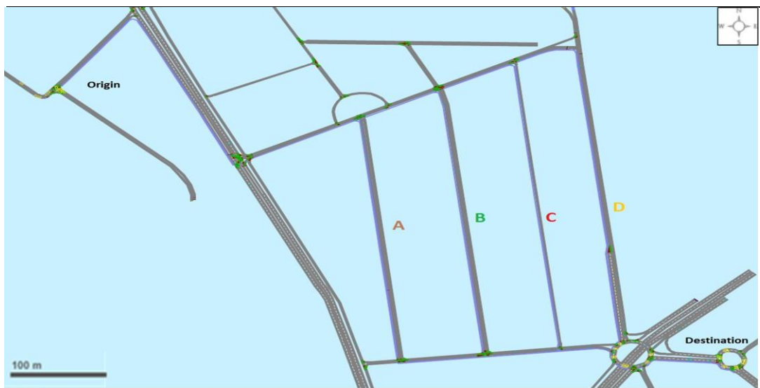
Figura 2: Rede desenvolvida no modelo de tráfego VISSIM
