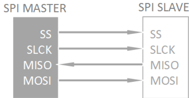
Figura 3.4: Esquema de ligação master-slave
