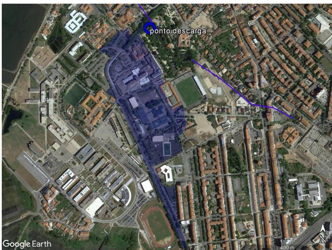
Figura 10: Ponto de descarga da Avenida Artur Ravara e toda a área de drenagem associada.
