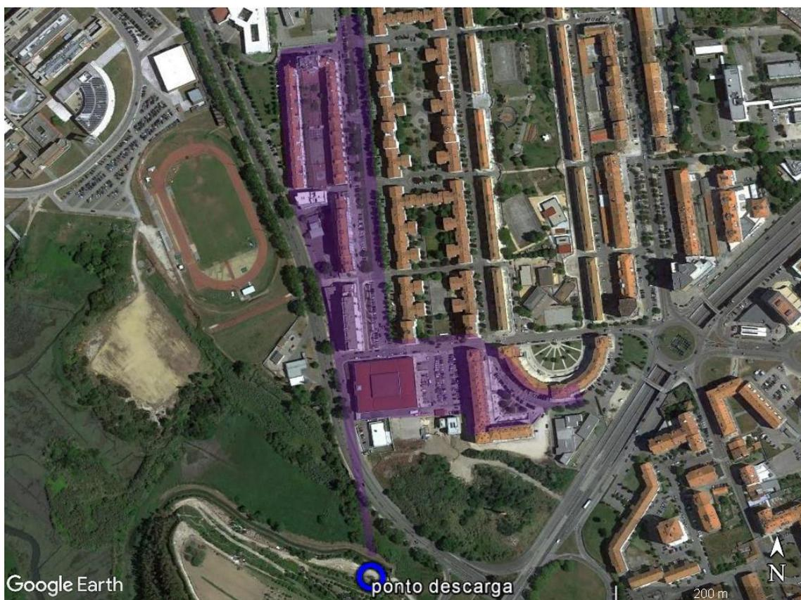
Figura 12: Ponto de descarga da urbanização Chave e toda a área de drenagem associada.
