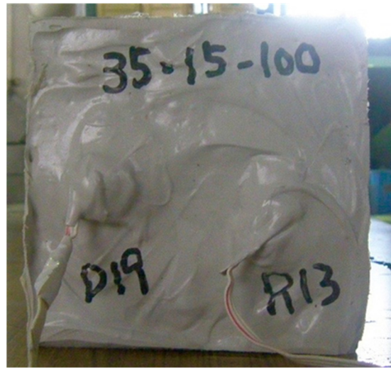
写真 5-1 四電極法、分極抵抗法および分極曲線法に用いた供試体の導線設置面
