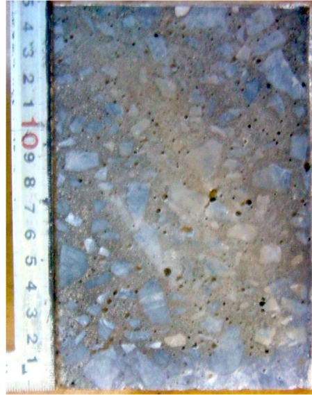
写真 3-23 硝酸銀噴霧の様子 (GGBF/B=60%, BFS, 蒸気養生後気中養生)
