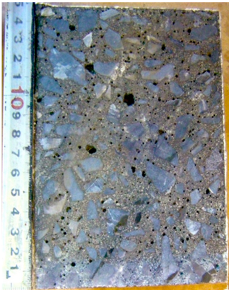
写真 3-24 硝酸銀噴霧の様子 (GGBF/B=60%, BFS, 蒸気養生後水中養生)
