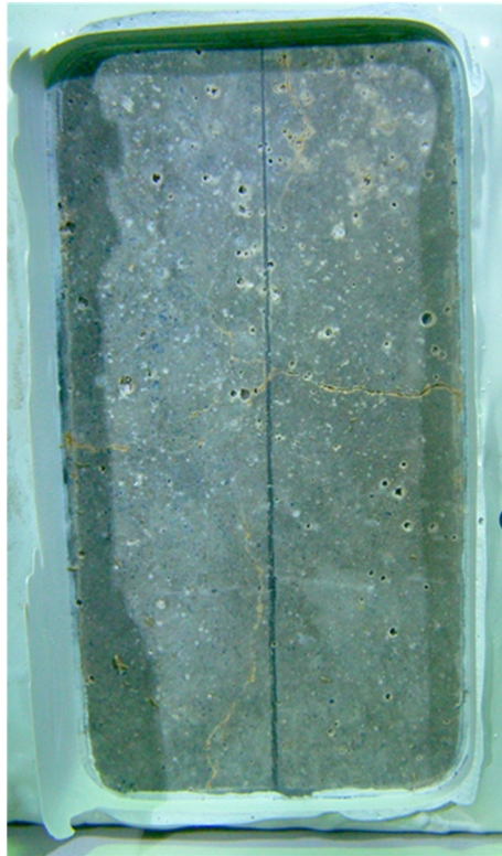
写真 5-9 ひび割れ発生のため発錆限界塩化物イオン量試験終了 になった供試体
