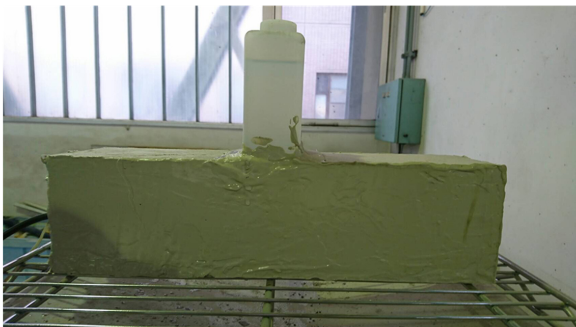
写真 5-7 発錆限界塩化物イオン量試験の様子(側面)
