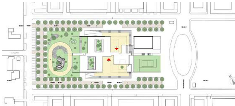
Fig. 4.21. Planimetria generale di progetto, all'interno delle previsioni del Piano di Zona. E' possibile notare come il progetto utilizzi il verde come recinzione naturale in cui inserire i percorsi pedonali interni ed esterni di relazione con il quartiere. L'ingresso è segnato dall'isola ellissoidica che divide i flussi di traffico su sensi di marcia opposti e delimita l'area di accesso alla scuola (da Selicato, Rotondo, 2010, fig. 9, p.27)
