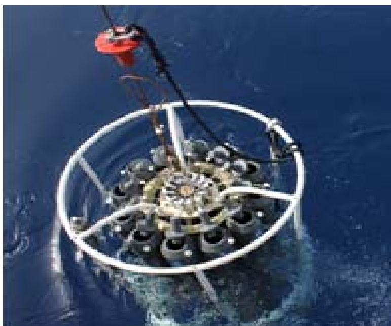
Figura 11: Fase di immersione della sonda CTD multiparametrica “ SBE 9/11plus ”
