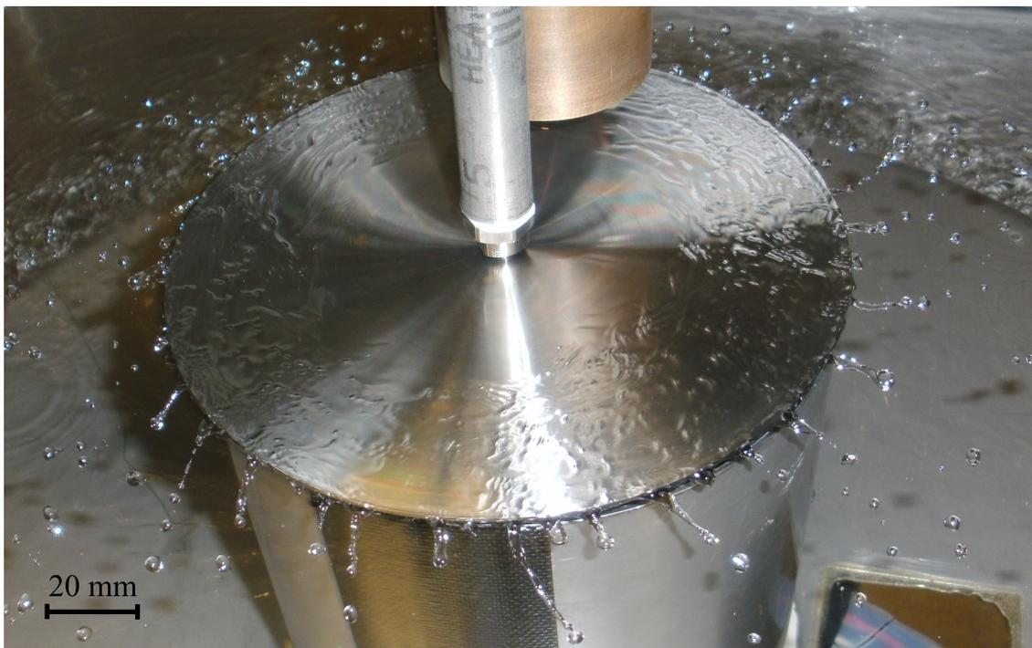
**Abbildung 6.1:** Fotografie der Rotationsscheibe für einen Düsendurchmesser  $d_D = 1,03$  mm, einen Düsenabstand  $h = 1,5$  mm, einen Fluidmassenstrom  $\dot{M} = 50$  kg h<sup>-1</sup> und eine Drehzahl  $U = 250$  min<sup>-1</sup>.
