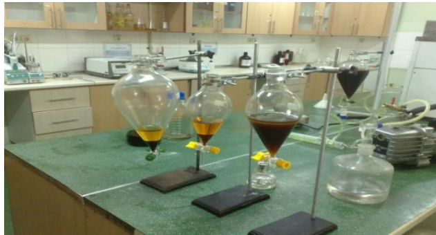
شکل ۲: دو فاز شدن بیودیزل و گلیسرین در طی مدت زمان ته‌نشینی ۱۲ ساعته
