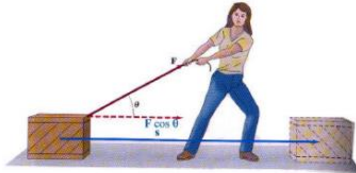
Gambar 3. Gaya membentuk sudut yang bekerja pada balok
