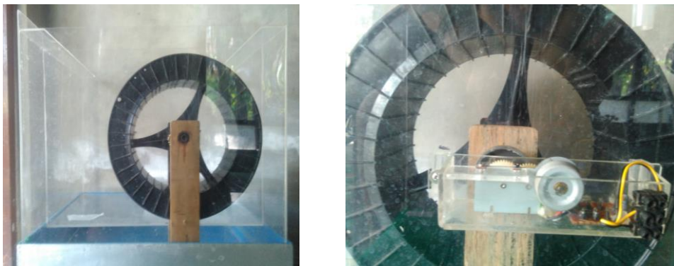
Gambar 6. Pemasangan Kincir Air dan Generator
