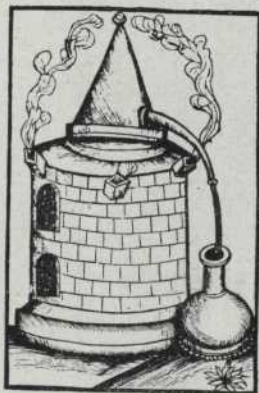
Fig. 5 Alambic senzill de l'any 1500, segons H. BRUNS- CHWYG
