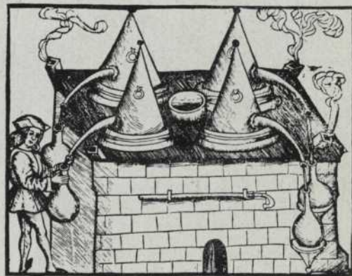
Fig. 6 Alambic de forn amb quatre retortes, segons H. BRUNSCHWYG
