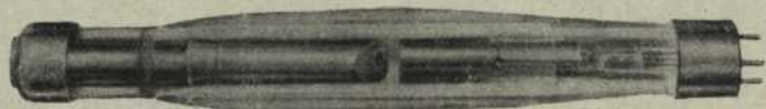
Fig. 9.—Tub Douglas (Siemens Reiniger Veifa) per a ésser usat en els dispositius Tuto de protecció total, refrigerat amb petroli, per a diagnòstic o teràpia.
