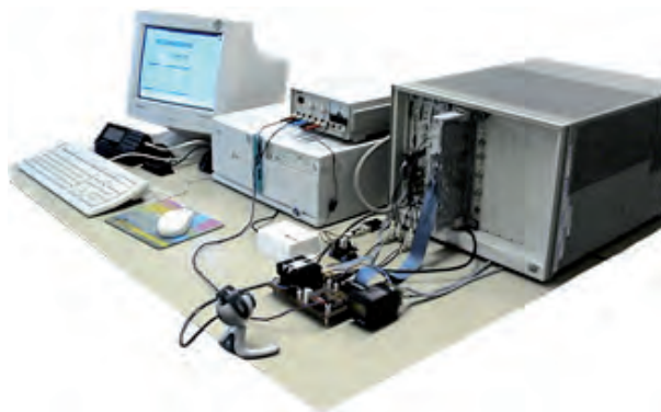
FIGURA 2. Laboratori remot VirtualLab basat en un instrument modular VXI.
