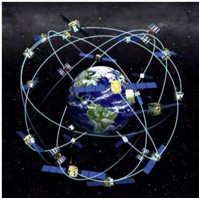
Figura 4: El sistema de posicionament global GPS consta de 24 satèl·lits que orbiten la Terra a una alçada de 20.200 km
