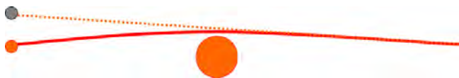
Figura 6: La relativitat general prediu el desviament de la llum quan passa a prop del Sol. Una estrella com la de la figura es veuria des de la Terra en una posició aparent desviada en un angle de 1,7505" d'arc.
