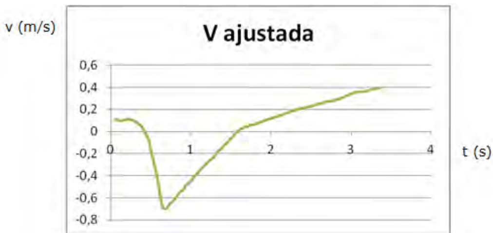
Fig. 8: Gràfica velocitat-temps ajustada a partir de la gràfica anterior.
