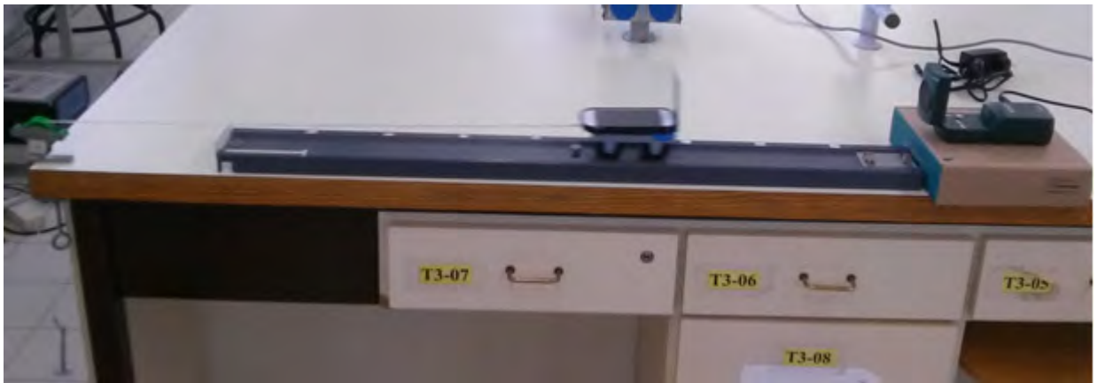
Fig. 1: Muntatge experimental del cotxet, lligat a la corda, que es desplaça pel carril.
