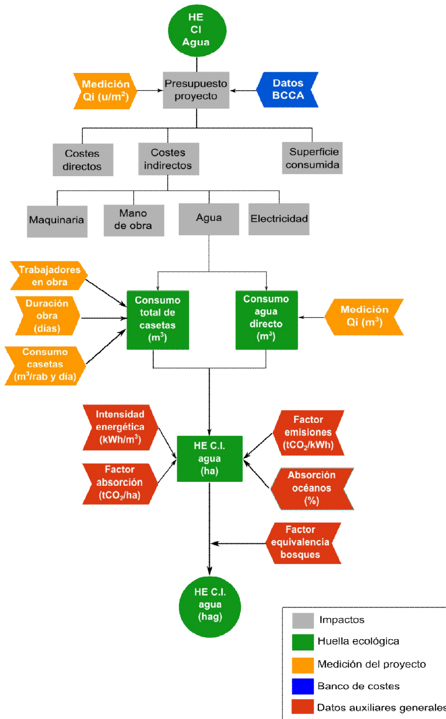
Figura 35.- Esquema de cálculo de la HE producida por el consumo de agua
