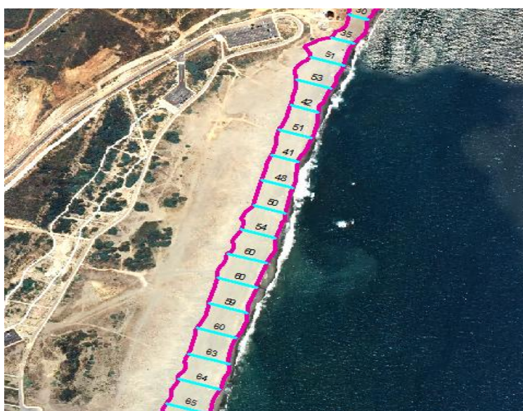
Figura 9: Estimación anchura media de la playa utilizando transectos generados con DSAS. Fuente: Elaboración propia.
