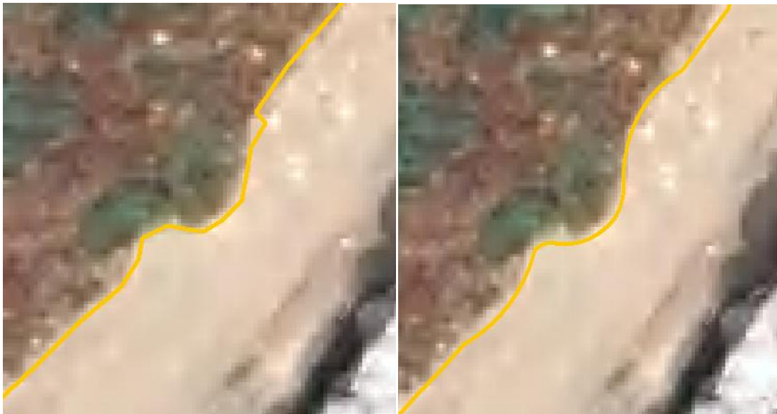
Figura 11: Ejemplo suavizado línea digitalizada. Fuente: Elaboración propia
