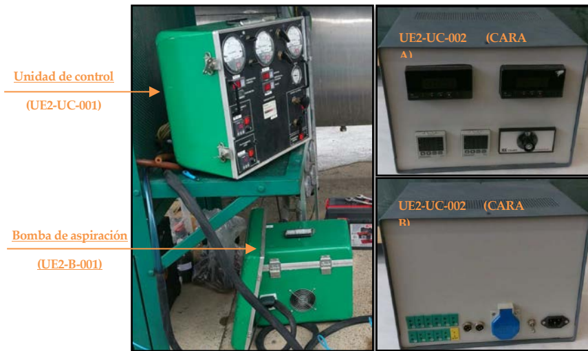
Figura 3-38 Unidad de control para el accionamiento de la bomba de aspiración (Imagen de la izquierda) y unidad de control de temperaturas (Cara
