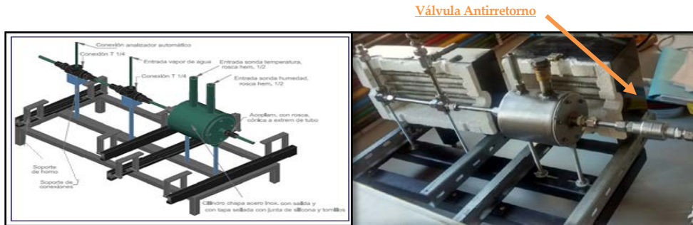
Figura 3-26 Diseño por ordenador y fotografía de detalles internos de las Cámaras de calentamiento de UE1-H-001 [Elaborado por Atercan]
