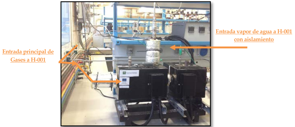
Figura 3-19 Entradas al horno precalentador (UE1-H-001)
