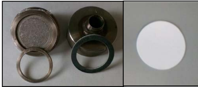
Figura 3-36 Imágenes de UE2-PFP-001 (a la izquierda) y filtro UE2-F-002 (a la derecha) utilizados para la segunda unidad de ensayos
