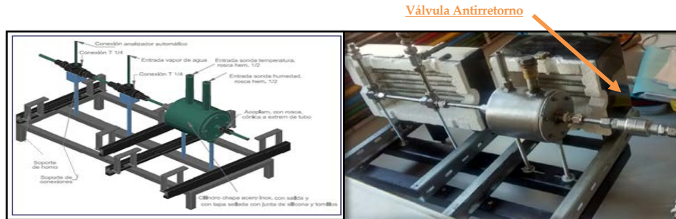
Figura 3-26 Diseño por ordenador y fotografía de detalles internos de las Cámaras de calentamiento de UE1-H-001 [Elaborado por Atercan]
