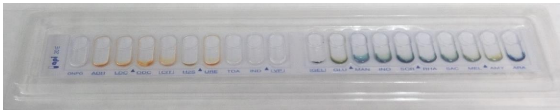
Figura 19. Galería API 20E con 20 microtubos
