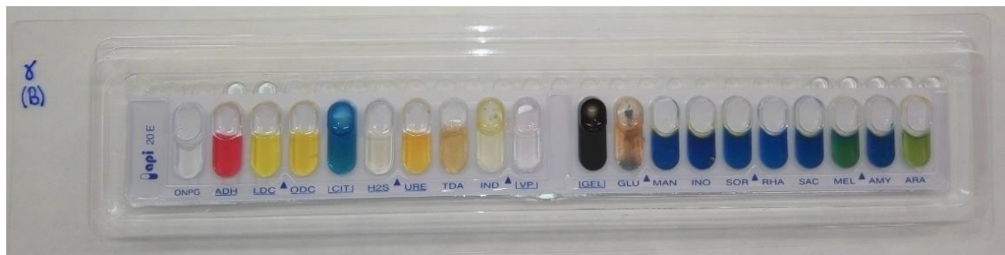
Figura 44. Prueba del API 20E para la bacteria B tras añadir los reactivos.
