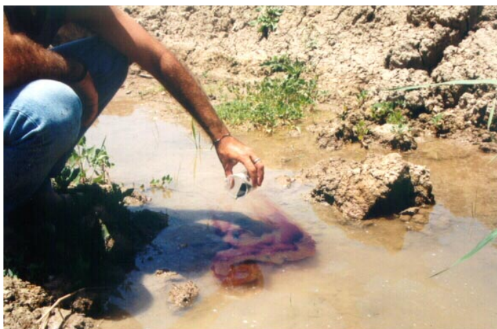
Foto 1: Ensayo en la balsa de Entremuros con permanganato potásico
