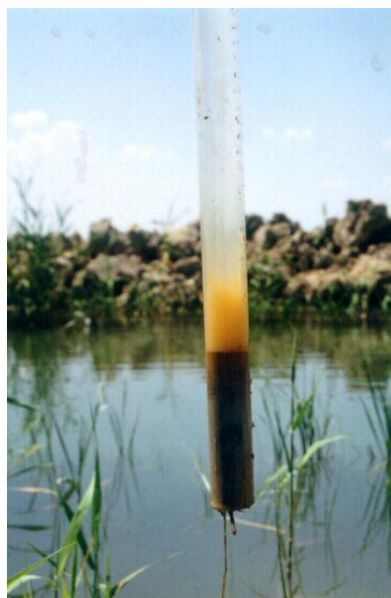
Foto 1: Muestreo de fango con barrena de metacrilato
