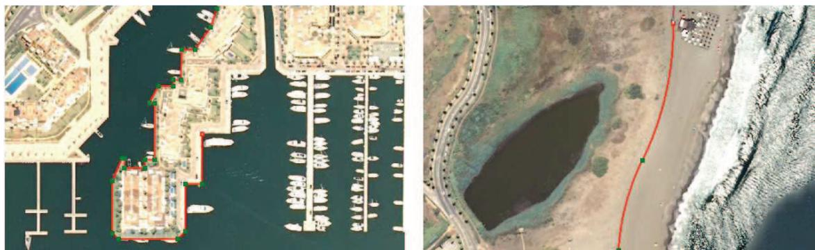
Figura 3.17. Izquierda: digitalización con línea recta en elementos antrópicos. Derecha: digitalización con línea tangente en contactos naturales.
