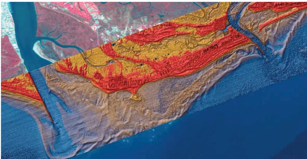
Figura 2.11. Imagen realizada con datos del sensor LiDAR batimétrico “HawkEye II” para el delta submarino y sistema litoral asociado a la desembocadura del Guadiana.
