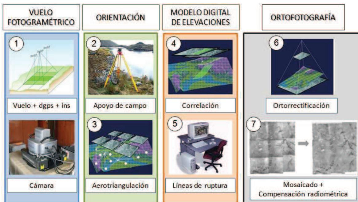
Figura 3.5. Proceso de generación de una ortofotografía digital.
