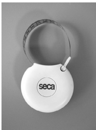
Fig. 13: Cinta métrica empleada para las mediciones de los perímetros. En el centro: sistema de ajuste automático de la presión ejercida por la cinta sobre el segmento corporal
