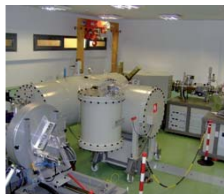
Figura 4. Sistema de Espectrometría de Masas con Aceleradores (AMS) del CNA.
