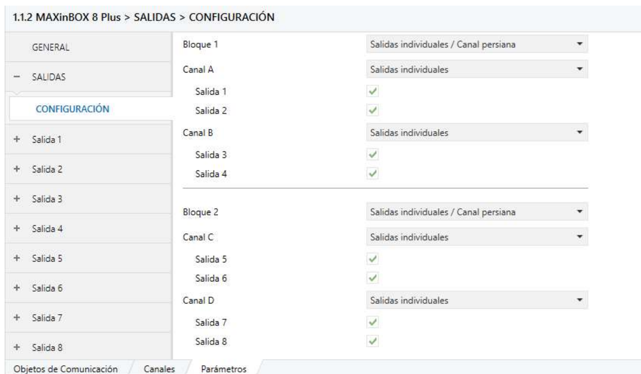
Figura 43. Configuración de las salidas del MAXinBOX 8 Plus
