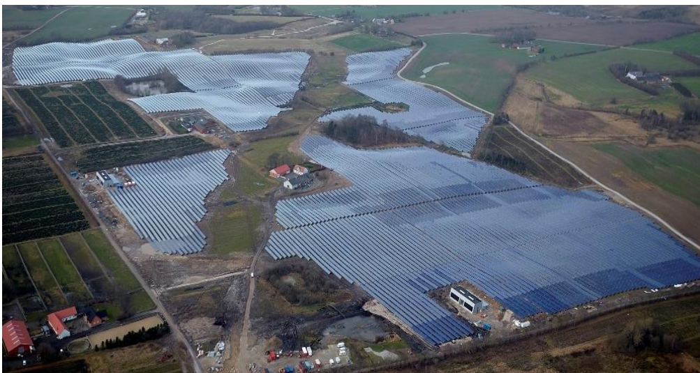
5. ábra: A silkeborgi napkollektorostávfűtő rendszer madártávlatból (forrás: GSTEC 2017)
