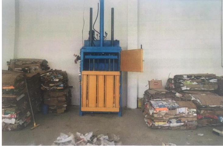
Şekil 2: Ambalaj atığı toplama ayırma tesisi uygulamaları, pres makinesi
