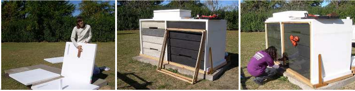
Figura 9: Montaje de los BOX con la instalación completa de los MAC y sensores.
