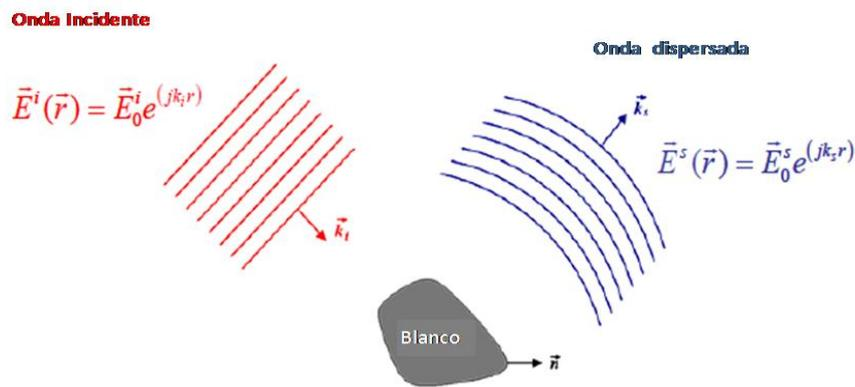
**Figura 3.** Interacción de una onda electromagnética y un blanco.
