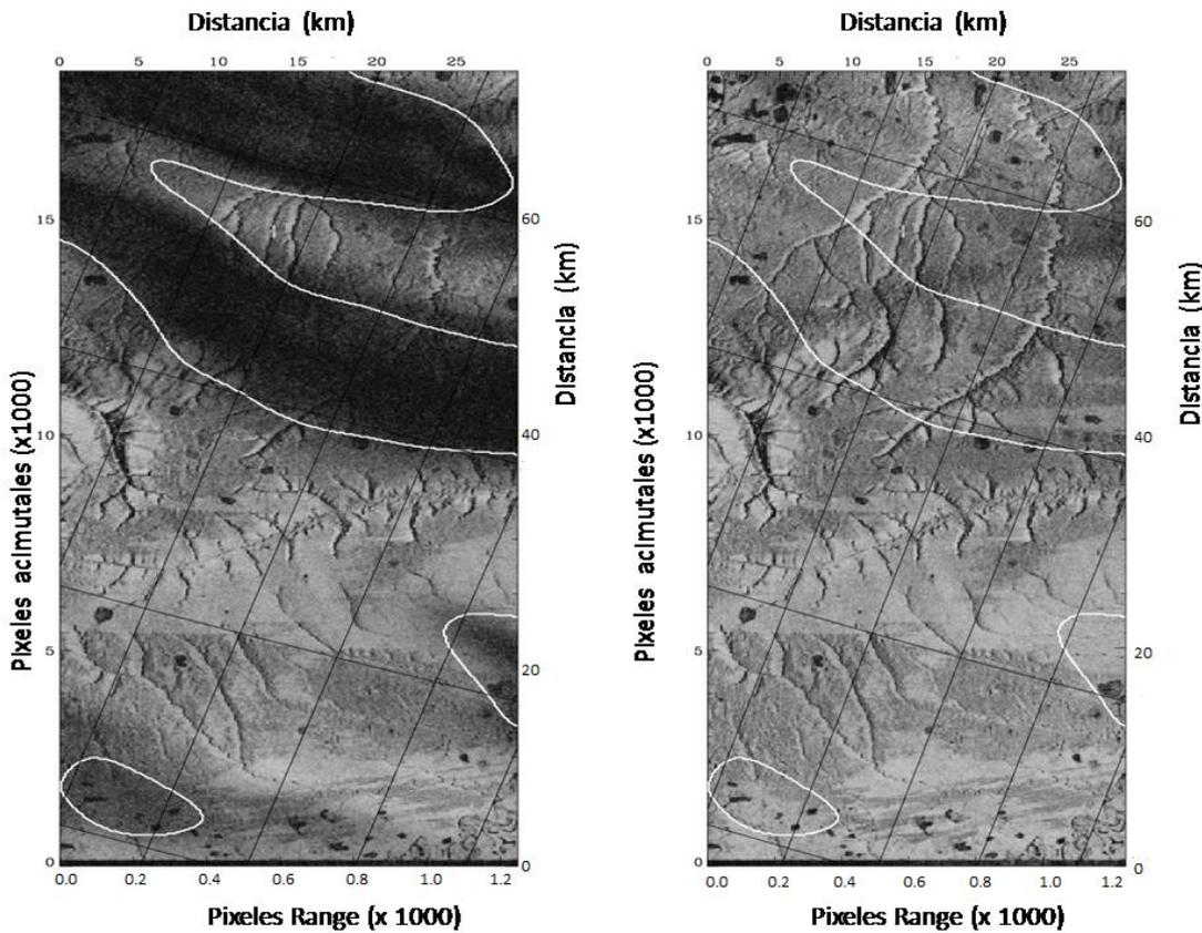
**Figura 6.** a). Imagen de Collville, Alaska antes (53). b). Después de la corrección de acimut (53).
