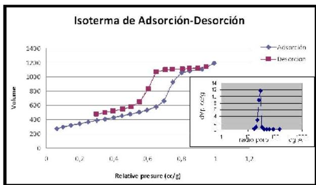
Fig. 3. Isotherma de Adsorción-Desorción del Cu-BA15.
