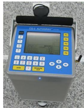
Figura 4. Gravímetro Scintrex CG-5
