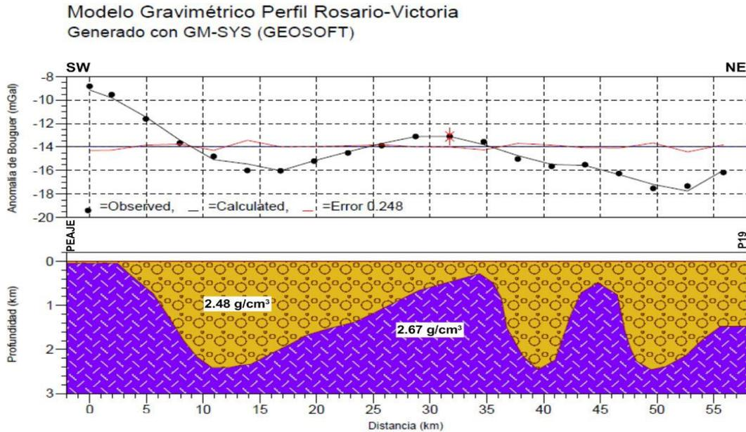
Figura 9. Modelo determinado con el software Geosoft.
