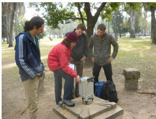
Figura 6. Medición con gravímetro absoluto Scintrex sobre el Nodal del Rosario
