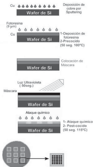
Figura 4.- Diagrama del proceso de micromaquinado de una estructura mediante fotolitografía sobre un sustrato de Silicio.
