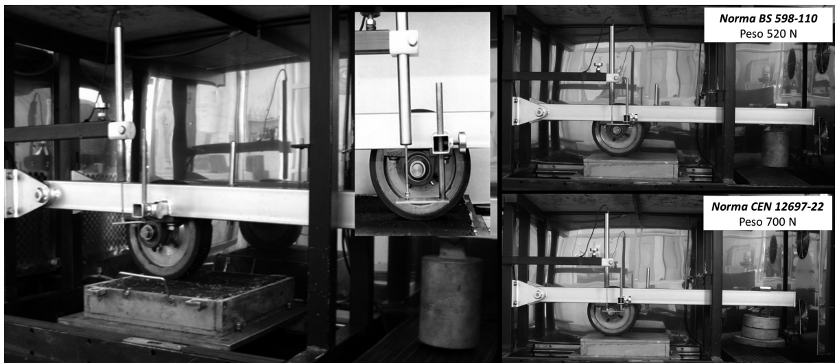
Figura 2. Equipo de Wheel Tracking Test y detalles de la configuración para cada metodología.
