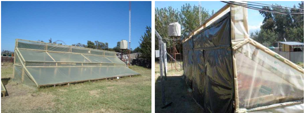
Fig. 1. Vista del secadero con colector, cámara de secado con salida tipo chimenea
