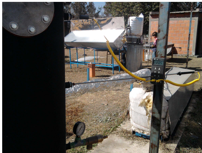
Figura 3: Foto de los instrumentos de medición del recinto, manómetro y termómetro digital
