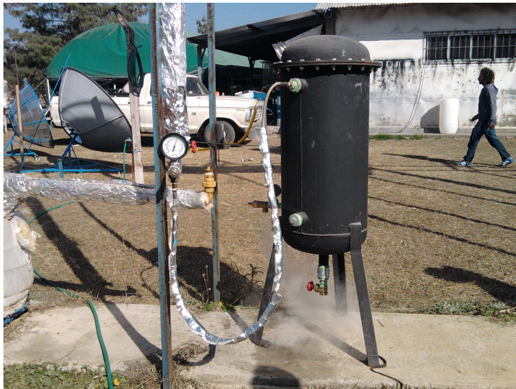
Figura 4: Recinto de vaporización conectado al generador de vapor
