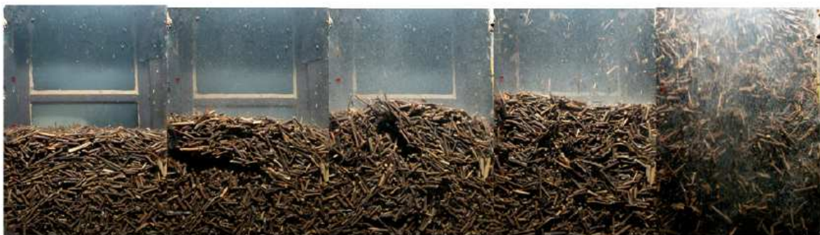
Figura 10: Fluidización del lecho de biomasa. Incremento de u_s de izquierda a derecha (Zhang y colab., 2011).
