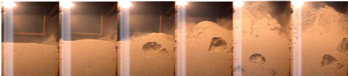
Figura 4: Fluidización del lecho de arena. Incremento de u_s de izquierda a derecha (Zhang y colab.,2011).
