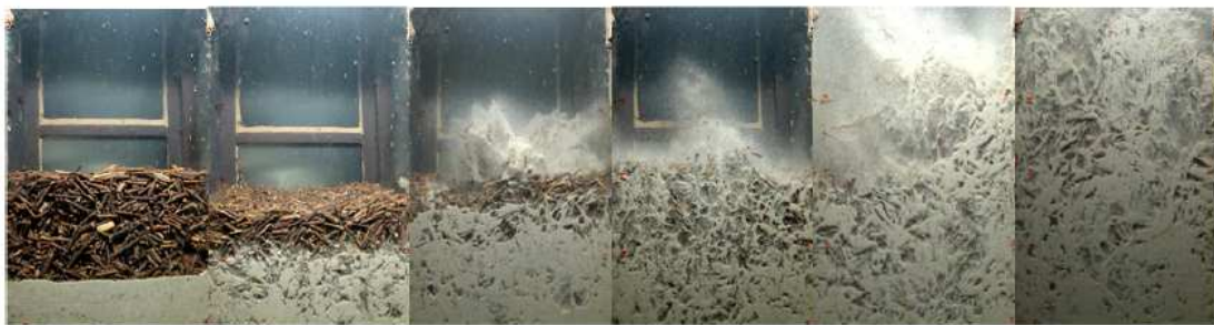
Figura 16: Fluidización del lecho biomasa-arena, X_v = 0.5 . Incremento de u_s de izquierda a derecha (Zhang y colab., 2011).
