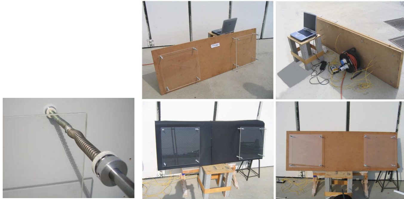
Sperimentazione in laboratorio dei dispositivi a memoria di forma, testati per la movimentazione in funzione della temperatura di una lastra in policarbonato trasparente
