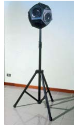
Fig. 357 Diffusore dodecaedrico con piantana (sorgente acustica omnidirezionale) (Fonte: Orione s.r.l.).
