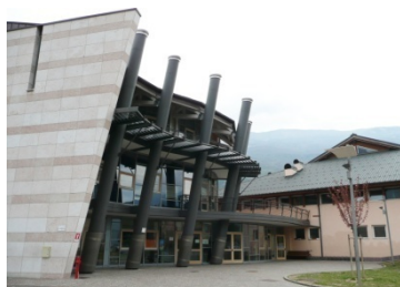
Fig. 406 Scuola primaria, Marco di Rovereto (TN) – arch. Gianluca Perottoni. Le ampie vetrate sono protette da un doppio sistema costituito da schermature fisse (aggetti) e da filtri solari fissi orizzontali.
