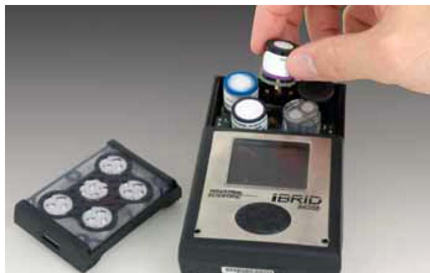
Fig. 343 Analizzatore di gas portatile: inserimento delle capsule di rilevazione specifiche per ogni gas (Fonte: Industrial Scientific).
