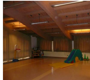
Fig. 440 Scuola per l'infanzia, Volano (TN) – arch. Gianluca Perottoni. Le schermature interne devono garantire un buon grado di oscuramento per permettere il riposo pomeridiano dei bambini.
