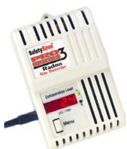
Fig. 344 Analizzatore di radon portatile (Fonte: FamilySafety).
