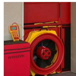
Fig. 346 Strumentazione per Blower Door Test (Fonte: Retrotec).
