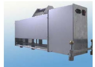
Fig. 358 Generatore di rumore da calpestio (Fonte: Orione s.r.l.).
