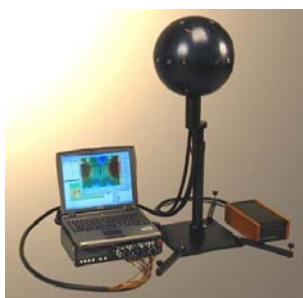
Fig. 359 Strumentazione per il beamforming (Fonte: NoiseVision)
