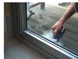
Fig. 347 Generatore di nebbia (Fonte: Retrotec).
