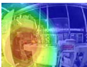
Fig. 360 Visualizzazione della sorgente acustica e delle relative intensità (Fonte: NoiseVision).
