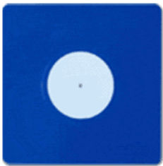
Fig. 328 Target per l'acquisizione dei punti notevoli e per la referenziazione delle stazioni.
