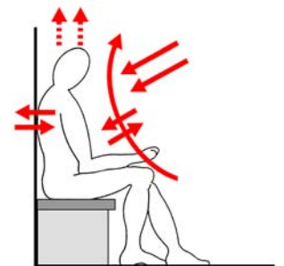
Fig. 270 Schematizzazione degli scambi termici che il corpo umano è in grado di innescare rispetto all'ambiente che lo circonda.
