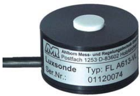
Fig. 339 Sonda per flusso luminoso di tipo puntuale (Fonte: Ahlborn).
