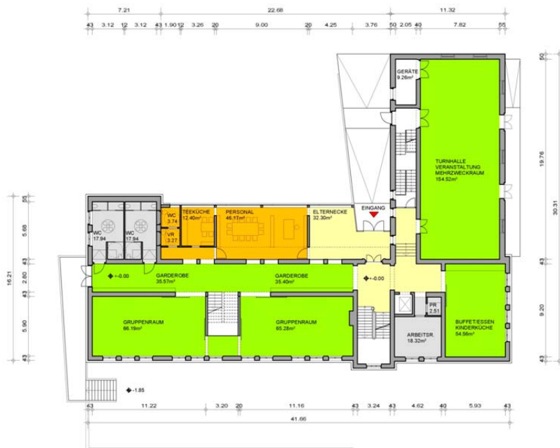
Fig. 115 Progetto: Planimetria del piano terra con inserimento del nuovo volume d'ingresso.
