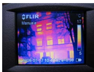
Fig. 353 Display della termocamera in azione. (Fonte: Pancaldi A., Papi A., op. cit., Allegato 6).
