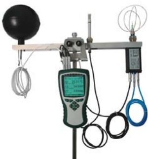
Fig. 340 Stazione meteo integrata per la valutazione del comfort termico (Fonte: Ahlborn).
