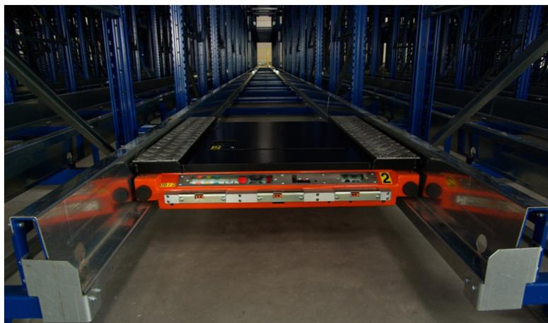
**Figura 1.5.** Satellite a servizio della scaffalatura a profondità multipla. Fonte: [www.modulblok.com](http://www.modulblok.com)
