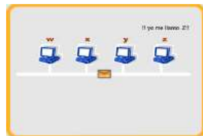
Figura 1: Topologia amb forma de Bus [3]
