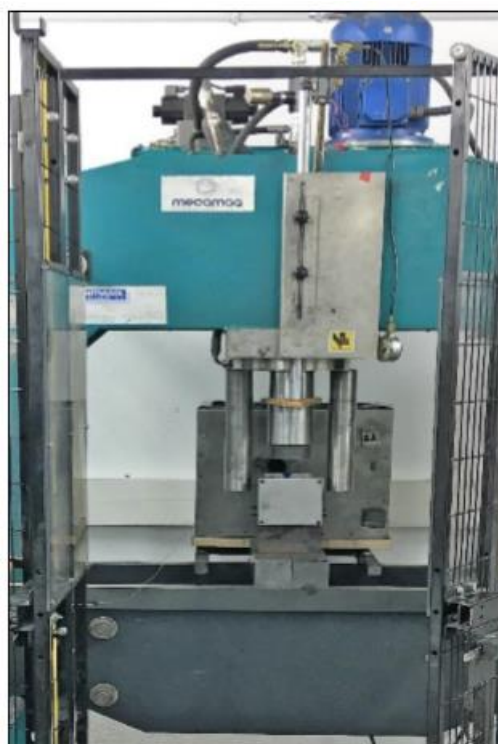
Figura 3-13 Montaje de Matriz y termopar en prensa hidráulica
