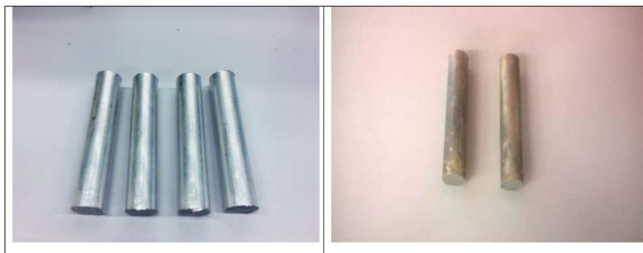
Figura 3-10 Aspecto de las muestras antes (a la derecha) y tras el prerrecocido (a la izquierda)
