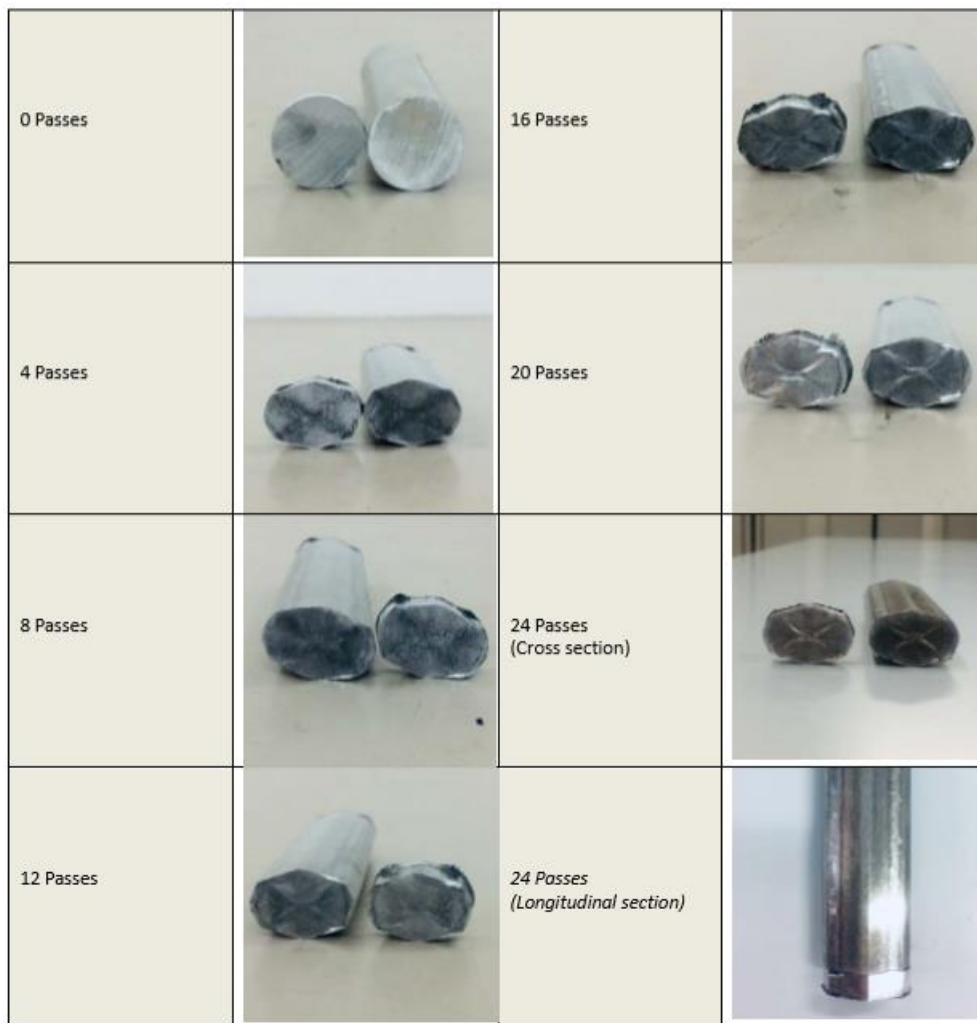
Figura 3-14 Evolución de una de las probetas al aumentar el número de ciclos
