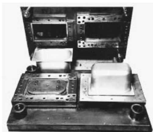
Herramienta de desbarbado y corte de cantos fabricada con ARNE para recipientes de chapa de acero inoxidable de 0,914 mm de espesor y unas dimensiones de 254 x 152 x 203 mm.
