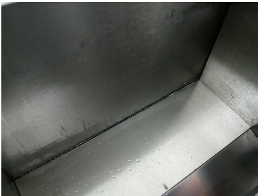
Figura 5-4 Daño de las guías laterales
