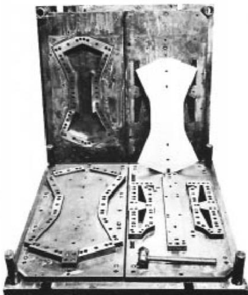
Herramienta de troquel fabricada en acero ARNE mecanizado de precisión.
