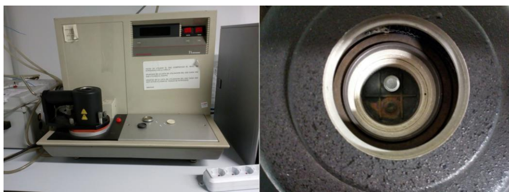
Figura 3-7 Equipo de DSC (a la izquierda) con se celda de medición (a la derecha)
