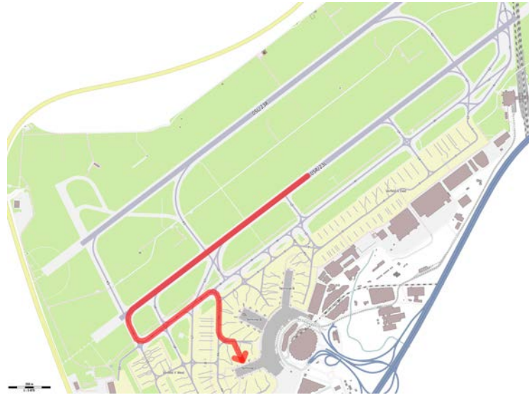
Abbildung A.10: Rollweg des A380 bei Landung auf der Piste 23L. Der A380 rollt bis zum Ende der Piste und verlässt diese über die Rollbahn L9. Anschließend rollt er über die Rollbahn M und P4 zum Gate C2 am Terminal C des Flughafens Düsseldorf. (Quelle: OpenStreetMap contributors (Licence ODbL) [62])
