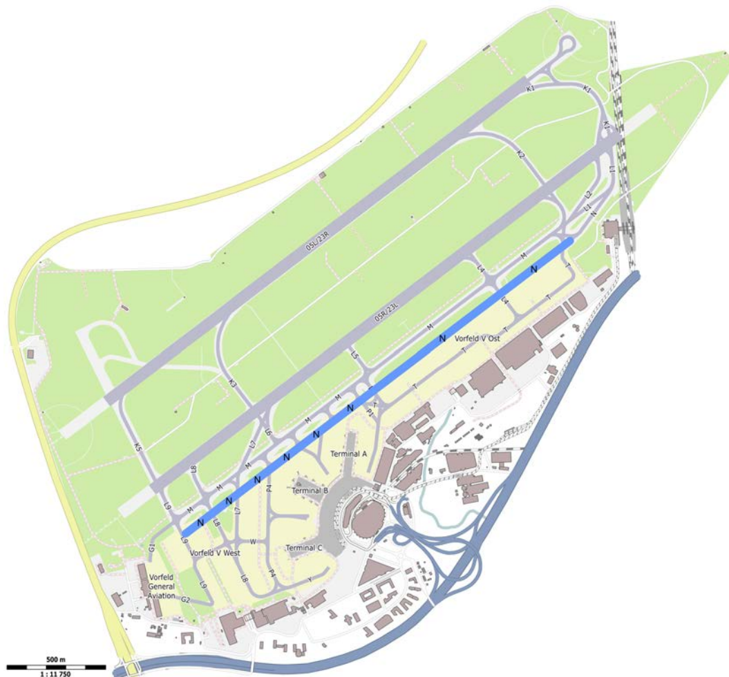
Abbildung 5.13: Szenario 4: Bau einer durchgehenden Rollbahn N, parallel zu den Pisten und der Rollbahn M. (Quelle: OpenStreetMap contributors (Licence ODbL) [62])
