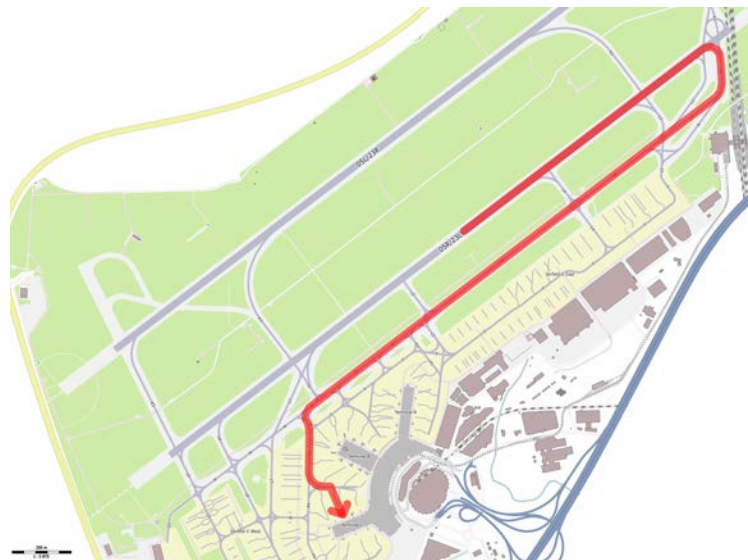
Abbildung A.8: Rollweg des A380 bei Landung auf der Piste 05R. Der A380 rollt bis zum Ende der Piste und verlässt diese über die Rollbahn L1. Anschließend rollt er über die Rollbahn M und P4 zum Gate C2 am Terminal C des Flughafens Düsseldorf. (Quelle: OpenStreetMap contributors (Licence ODbL) [62])
