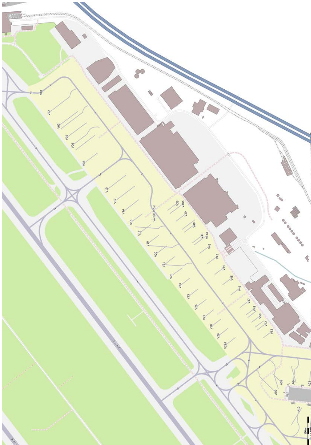
Abbildung 4.3: Vorfeld V Ost des Flughafens Düsseldorf (DUS / EDDL) mit dem zugehörigen Teil des Vorfelds V (Abstellpositionen V01 bis V53). Im Bereich von V17 bis V23 können an Stelle von fünf kleineren Flugzeugen drei große Flugzeuge abgestellt werden. (Quelle: OpenStreetMap contributors (Licence ODbL) [62])
