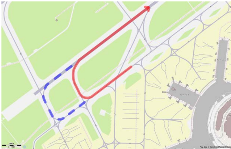
Abbildung A.6: Rollweg bei Nutzung des Verfahrens des Intersection take-offs bei Betriebsrichtung 05. Der Rollweg ist als rote Linie dargestellt. Er führt von der Rollbahn M über die Rollbahn L8 auf die Startbahn 05R. Üblicherweise rollt ein Flugzeug über die Rollbahn L9 aus die Startbahn 05R auf. Dieser Rollweg ist als blau gestrichelte Linie angedeutet. (Quelle: OpenStreetMap contributors (Licence ODbL) [62])
