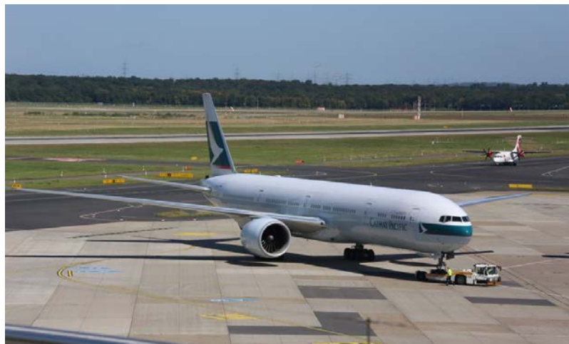
Abbildung 2.2: Pushback einer Boeing 777-300 der Cathay Pacific Airways am Flughafen Düsseldorf. Das Pushback erfolgt mit einem speziellen Fahrzeug, welches das Flugzeug rückwärts schiebt. Ein Ramp Agent überwacht das Schieben und steht in ständigem Kontakt mit dem Piloten des Flugzeugs. (Quelle: eigenes Bild)
