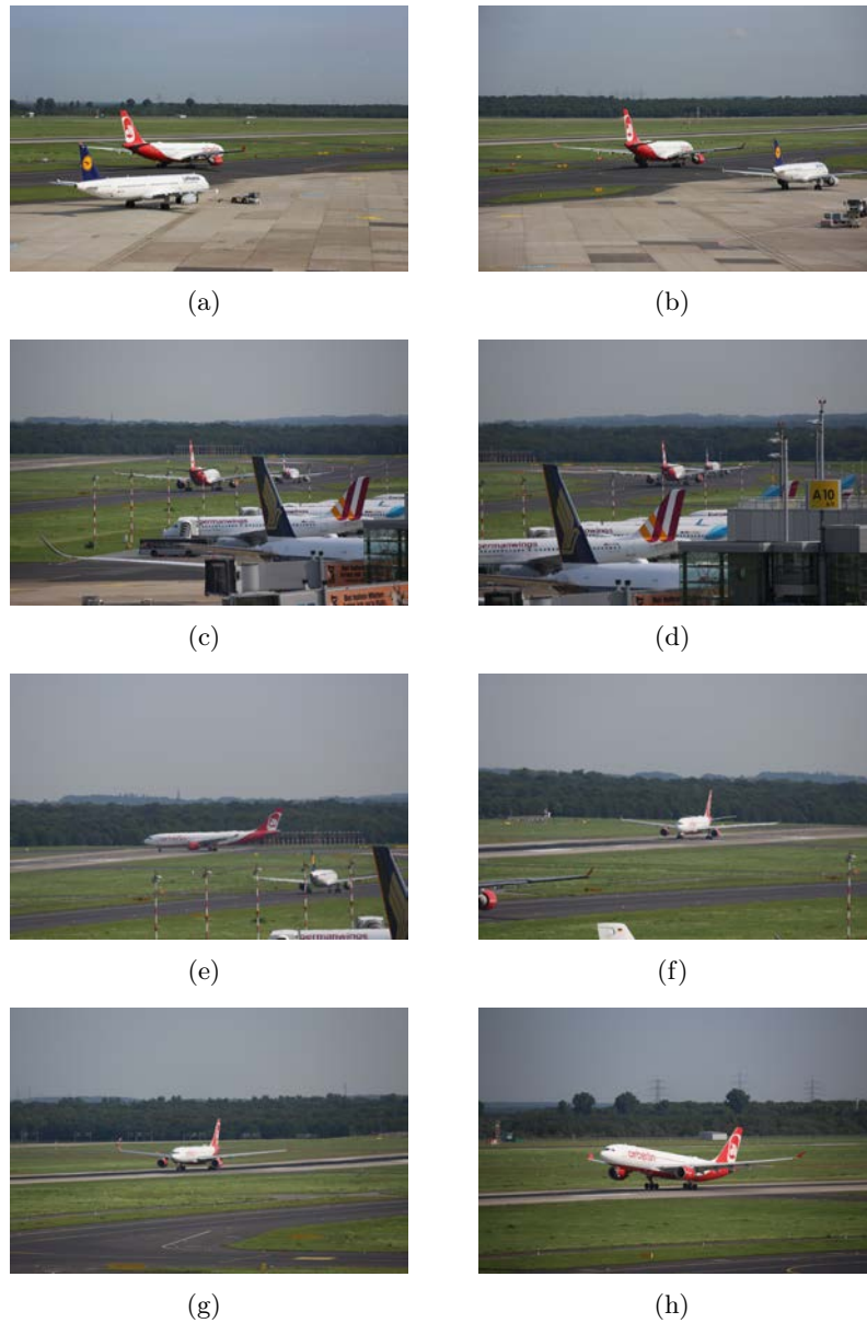
Abbildung A.3: Beispiel für die Aufnahme von Rollzeiten anhand von Realbildern eines A330-200 von Air Berlin. Die Bilder sind jeweils beim Passieren eines Checkpoints aufgenommen worden. Die Zeitstempel der Bilder geben nun die zugehörige Zeit des Passierens an. Aus diesen Zeiten lassen sich anschließend die Rollzeiten berechnen, die das Flugzeug für jeden Abschnitt benötigt hat. (Quelle: eigene Bilder)
