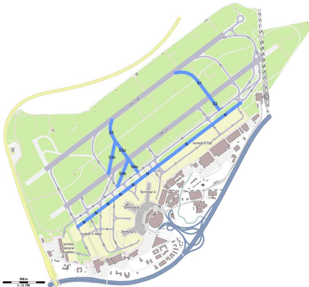
Abbildung 5.17: Szenario 5: Bau je einer zusätzlichen Highspeed-Abrollbahn für beide Betriebsrichtungen und Bau einer durchgehenden, parallel zu den Landebahnen verlaufenden Rollbahn N, parallel zu den Pisten und der Rollbahn M. (Quelle: OpenStreetMap contributors (Licence ODbL) [62])
