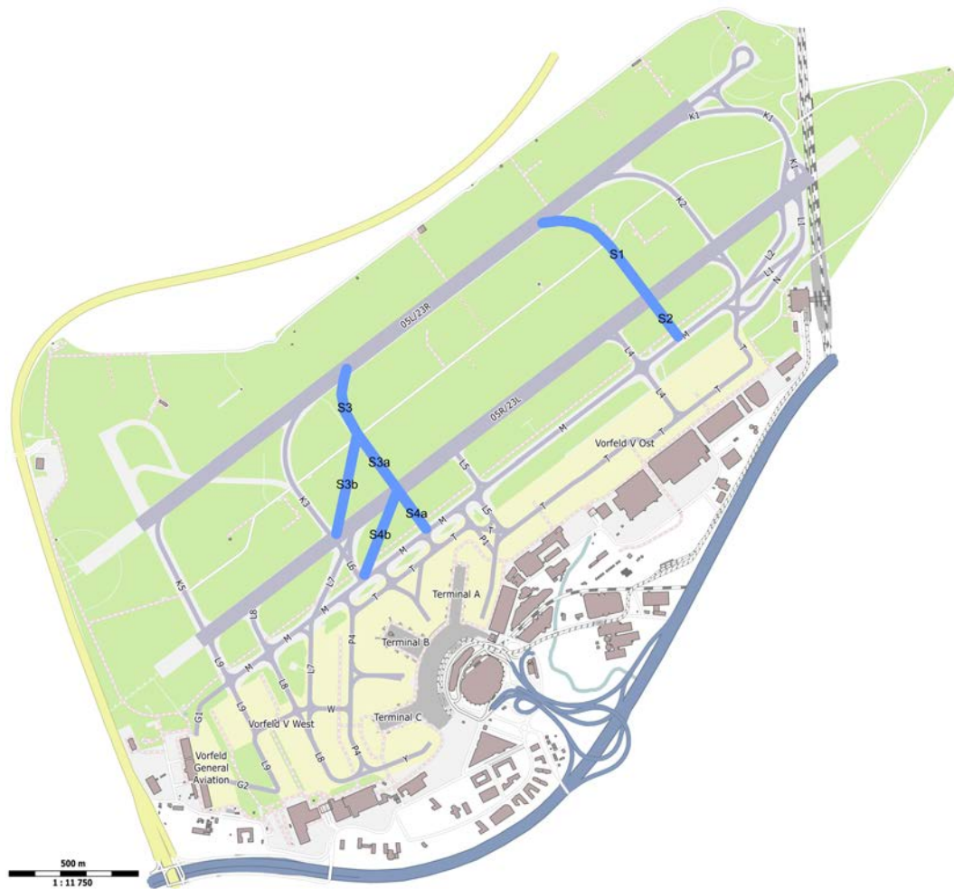
Abbildung 5.9: Szenario 3: Bau je einer zusätzlichen Highspeed-Abrollbahn bei beiden Betriebsrichtungen. Die neuen Rollwege werden als S1/S2 (Betriebsrichtung 05) und S3/S4 (Betriebsrichtung 23) bezeichnet. (Quelle: OpenStreetMap contributors (Licence ODbL) [62])
