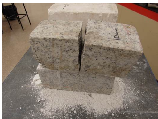
Figura 8: En el caso de la fábrica de granito, la probeta de junta gruesa ha roto como las precedentes, por fractura vertical de la pieza superior, con gran desprendimiento de mortero de los bordes. Hubo de suspenderse el ensayo de la muestra de junta fina, pues se alcanzó el tope de carga de la prensa. No llegó a haber pérdida de mortero en bordes
