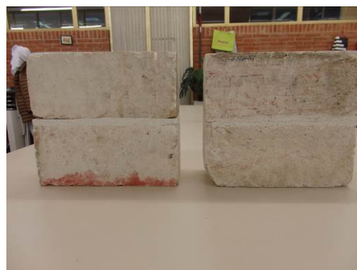
Figura 4: Juegos de probetas de fábrica preparados para el ensayo con Caliza. Puede apreciarse, a la derecha, el rejunto grueso, a la izquierda, el más fino
