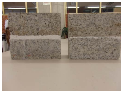
Figura 5: Juegos de probetas de fábrica preparados para el ensayo con Granito. Puede apreciarse, a la derecha, el rejunto grueso, a la izquierda, el más fino
