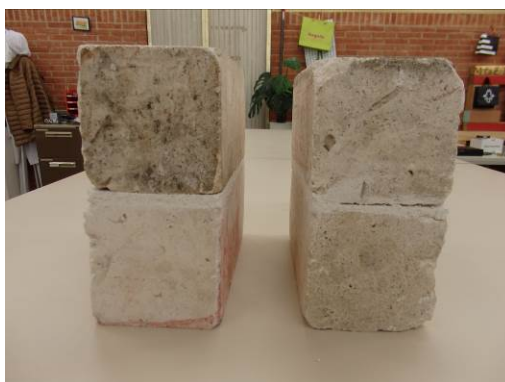
Figura 4: Juegos de probetas de fábrica preparados para el ensayo con Caliza. Puede apreciarse, a la derecha, el rejunto grueso, a la izquierda, el más fino
