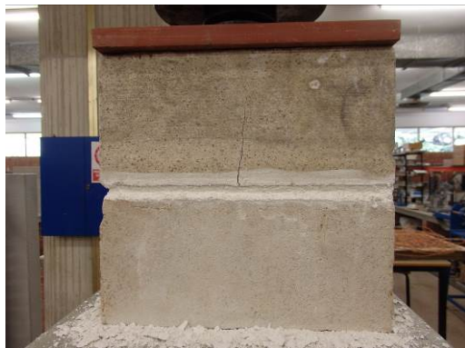
Figura 6: Rotura de la probeta con piezas de arenisca con junta fina. En la gráfica puede observarse en punto de rotura con un escalón de cedencia. El mortero de los bordes se ha desprendido
