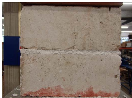
Figura 7: Como en el caso anterior la rotura de la probeta con piezas de caliza con junta fina se produce en el centro de la superior. También en la gráfica se aprecia el punto de rotura con un pequeño escalón de cedencia
