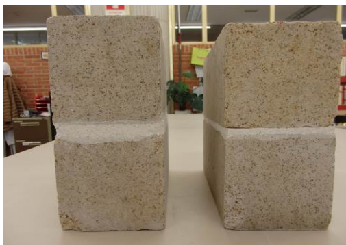
Figura 3: Juegos de probetas de fábrica preparados para el ensayo con Arenisca. Puede apreciarse, a la derecha, el rejunto grueso, a la izquierda, el más fino
