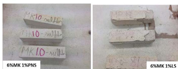
Figura 5. Comparativa en muestras con PNS y LS tras 5 ciclos de cristalización de sales
