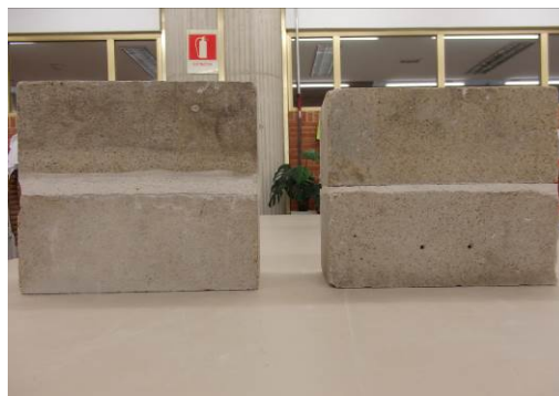
Figura 3: Juegos de probetas de fábrica preparados para el ensayo con Arenisca. Puede apreciarse, a la derecha, el rejunto grueso, a la izquierda, el más fino
