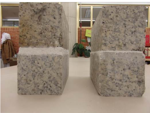
Figura 5: Juegos de probetas de fábrica preparados para el ensayo con Granito. Puede apreciarse, a la derecha, el rejunto grueso, a la izquierda, el más fino
