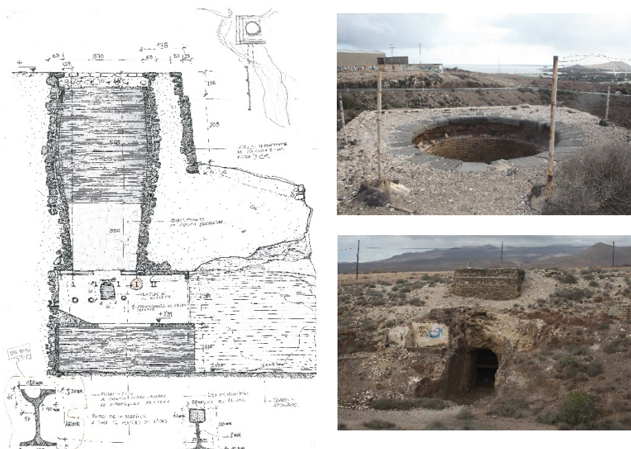
Figura 4: Sección del horno TEL 02 y vistas de la boca y acceso desde la cota inferior (Fuente: Manzano, J.)
