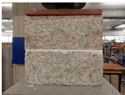
Figura 8: En el caso de la fábrica de granito, la probeta de junta gruesa ha roto como las precedentes, por fractura vertical de la pieza superior, con gran desprendimiento de mortero de los bordes. Hubo de suspenderse el ensayo de la muestra de junta fina, pues se alcanzó el tope de carga de la prensa. No llegó a haber pérdida de mortero en bordes
