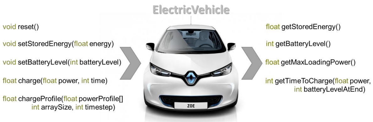
Abbildung 22: Methoden der ElectricVehicle Klasse (Bild: http://www.goingelectric.de/elektroautos/renault-zoe-2013 )
