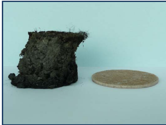
Imagen 21. Interdens antes de su exposición al fuego (2mm) y después (80-100mm).
