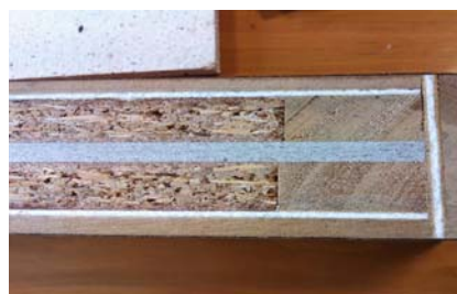
Imagen 19. Aplicación en el alma de una puerta y en el bastidor.
