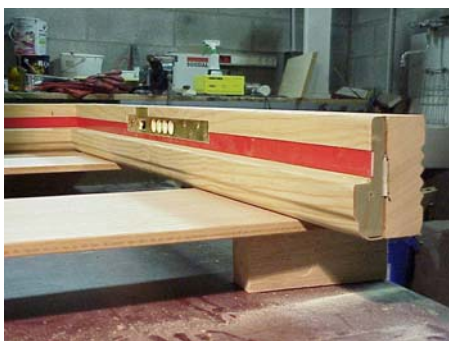
Imagen 18. Aplicación en el marco de una puerta RF.
