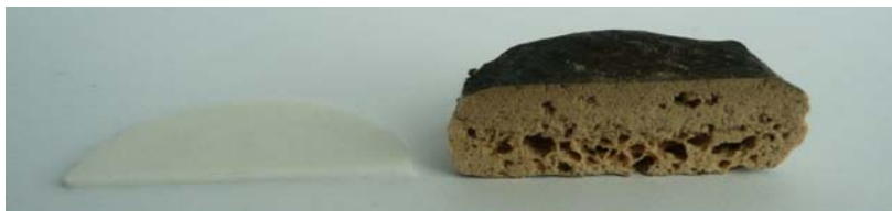
Imagen 17. Palusol antes de su exposición al fuego (2mm) y después (12mm).
