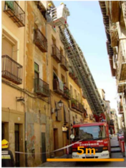
Imagen 1. Anchura de la calle insuficiente.
