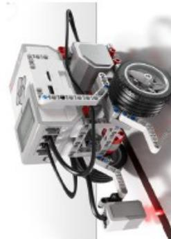
Il sensore ottico è collegato alla porta numero 3, mentre i motori che controllano le ruote sono collegati alle uscite B e C (più precisamente, il motore sinistro è collegato all'uscita B mentre quello destro all'uscita C).
