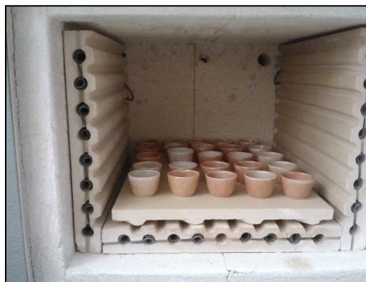
Mufla con crisoles y su molturación destinada al proceso de calcinación
