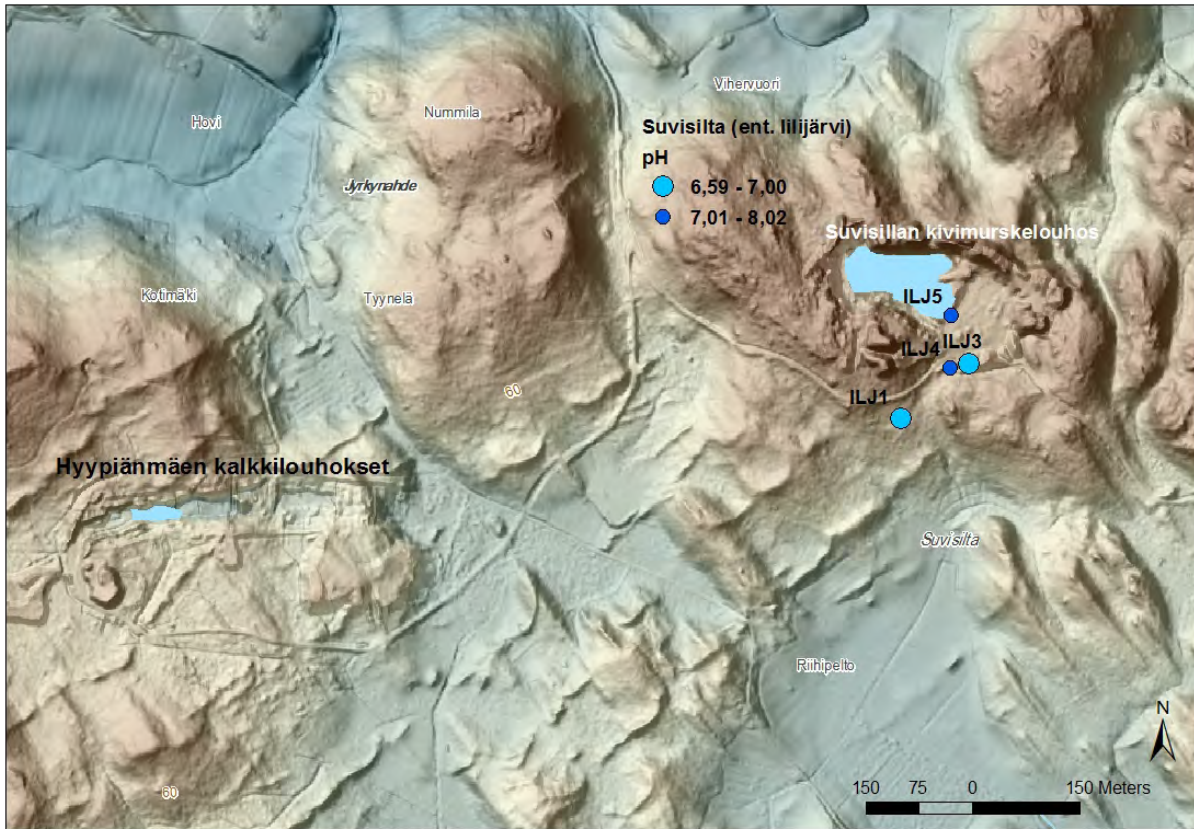
Kuva 15. Hyypiänmäen kalkkikaivoksen louhosten ja Suvisillan kivilouhoksen sijainnit hylättyä liljälän kaivosalueella, taustana laserkeilausaineisto, Salo, Varsinais-Suomi. Pallosymboleilla on merkitty Suvisillan kivilouhoksen ympäristön pintavesien pH-arvot (mitattu 11.5.2016) tunnuksineen (ks. Taulukko 8).
