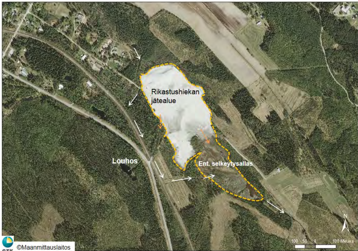
Kuva 38. Ilmakuvakarttaan merkitty Mätäsvaaran suljetun kaivoksen rikastushiekan jätealueen ja entisen selkeytysaltaan sijainti (oranssi katkoviiva) sekä pintavesien virtaussuunnat (valkoinen nuoli), Lieksa, Pohjois-Karjala (Räisänen ym. 2015a).
