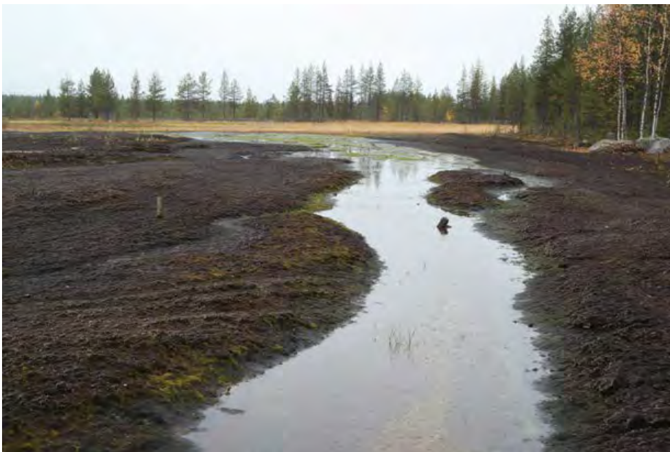
Kuva 29. Kärväsvaaran rikastushiekka-alueen läpi virtaavien ojien pH-arvo vaihteli 5,8–7,2 välillä syksyllä 2016, Kemijärvi, Pohjois-Suomi. (© A. Tornivaara, GTK)
