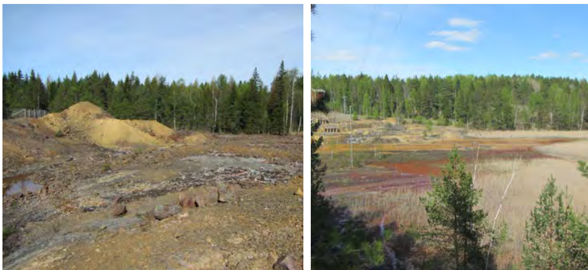
Kuva 39. Vasemmassa kuvassa Orijärven suljetun kaivosalueen pitkälle rapautuneen sivukiven jätealuetta. Oikeanpuoleinen kuva on otettu rikastushiekan jätealueen reunalta kohti rikastamon raunioita ja ruosteisen väristä vanha jätealuetta, jonka läpi uudemman rikastushiekka-altaan suotovedet virtaavat, Salo, Varsinais-Suomi. (© A. Tornivaara, GTK)
