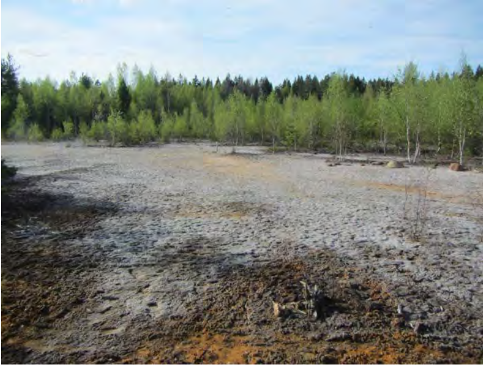
Kuva 4. Aijalan suljetun kaivoksen rikastushiekan jätealueen koillis- ja pohjoisosan kasviton alue, Salo, Varsinais-Suomi. Vaalean harmaa, ohutkerroksinen saostuma (härme) rikastushiekan pinnassa viittaa rikkiyhdisteen saostumiseen ja ruskea väri rautayhdisteiden saostumiin. (© A. Tornivaara, GTK)
