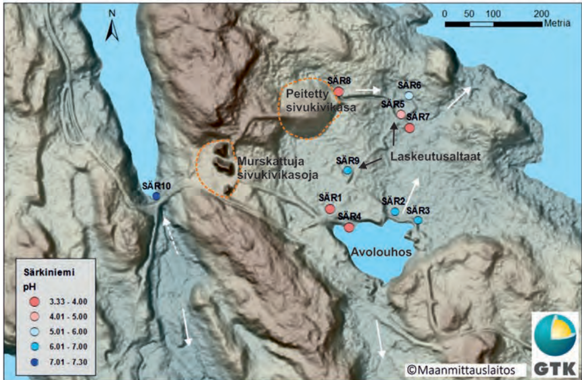
Kuva 52. Särkiniemen hylätyn kaivoksen sivukivialueiden sijainnit (oranssi katkoviiva), avolouhos (josta tunneli maanalaiseen kaivokseen) ja pintavesien virtausuunnat (valkoinen nuoli). 1.6.2016 mitatut pintavesien pH-arvot (Karlsson 2016) on esitetty kartassa pallosymbolein ja kohdetunnuksin (ks. tarkemmat arvot taulukosta 24), taustana laserkeilausaineisto, Leppävirta, Pohjois-Savo.
