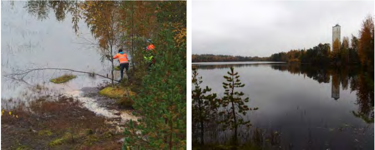
Kuva 60. Vasemman puoleisessa kuvassa pintaveden fysikaalista mittausta Ylöjärven suljetun kaivoksen rikastushiekan jätealueen padon läheisyydessä. Etualalla nähtävissä suotoveden synnyttämä uoma. Oikeanpuoleisessa kuvassa Parosjärvi, jonka pinnan alla on sijoitettuna kaivostoiminnan alkuvaiheen rikastushiekat, Pirkanmaa. (© H. Kovalainen, POPELY)
