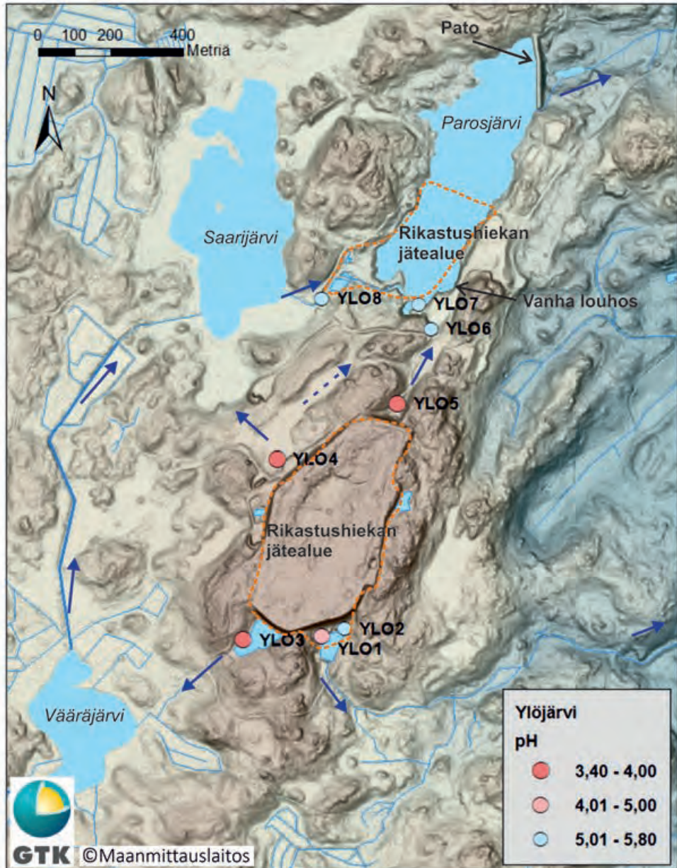
Kuva 61. Ylöjärven suljetun kaivosalueen rikastushiekan jätealueen (oranssi katkoviiva) sijainnit, pintavesien pH-arvot (pallosymbolit), kohdetunnukset (ks. Taulukko 29) sekä vesien virtaus-suunnat (sininen nuoli) pohjana laserkeilausaineisto, Pirkanmaa. Mittaukset tehty 27.9.2016.
