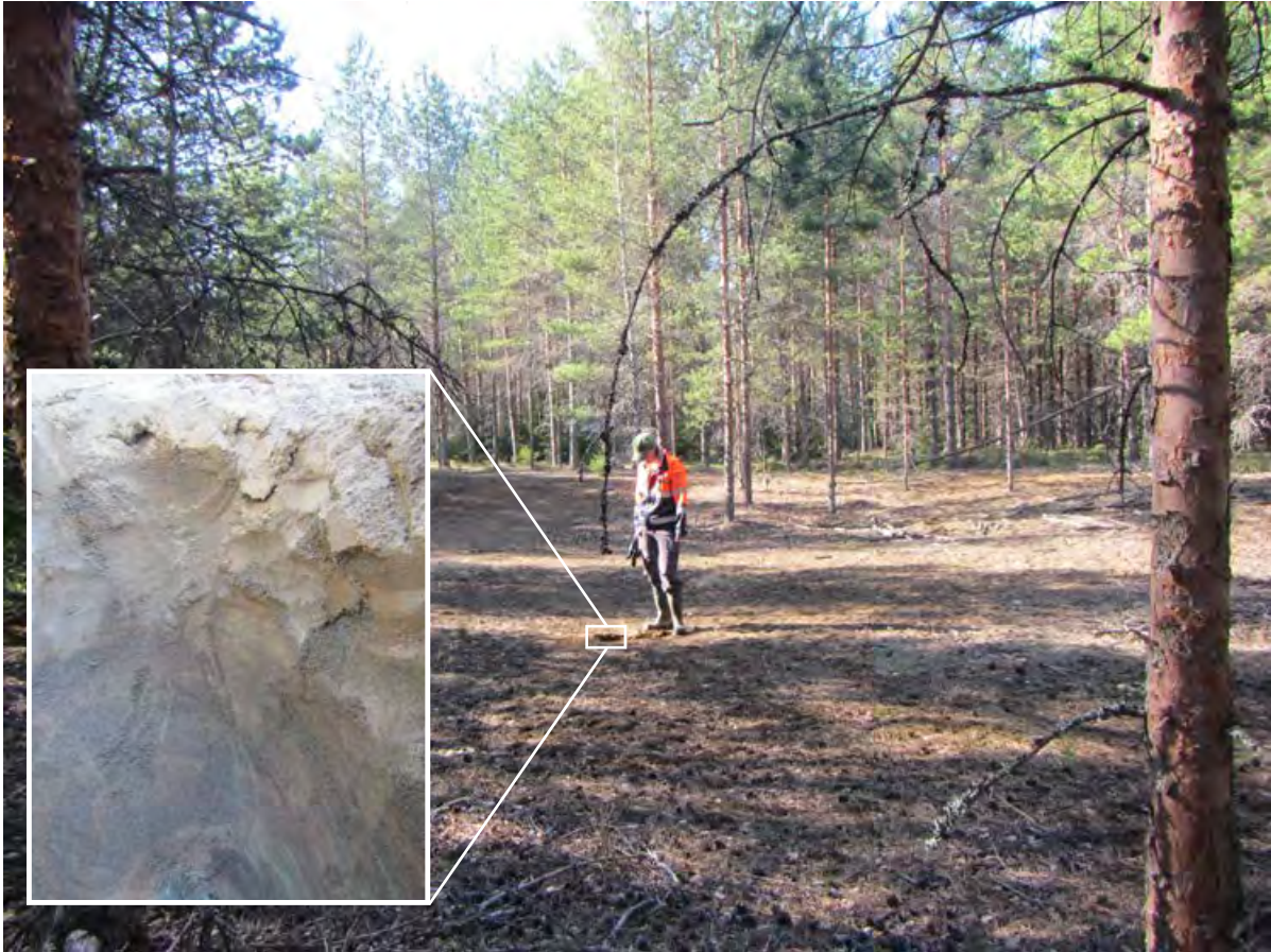
Kuva 27. Kylmäkosken suljetun kaivosalueen rikastushiekan jätealueen päällä kasvaa mm. mäntyjä, mutta peittämättömät osat alueesta ovat kasvittomia. (© M. L. Räisänen, GTK). Pienessä kuvassa on erotettavissa Fe-sulfidihapettumisesta ruskeaksi värjäytynyttä rikastushiekkää (oikean puoleinen kuva), kuopan syvyys n. 40 cm, Akaa, Varsinais-Suomi. (© A. Tornivaara, GTK)
