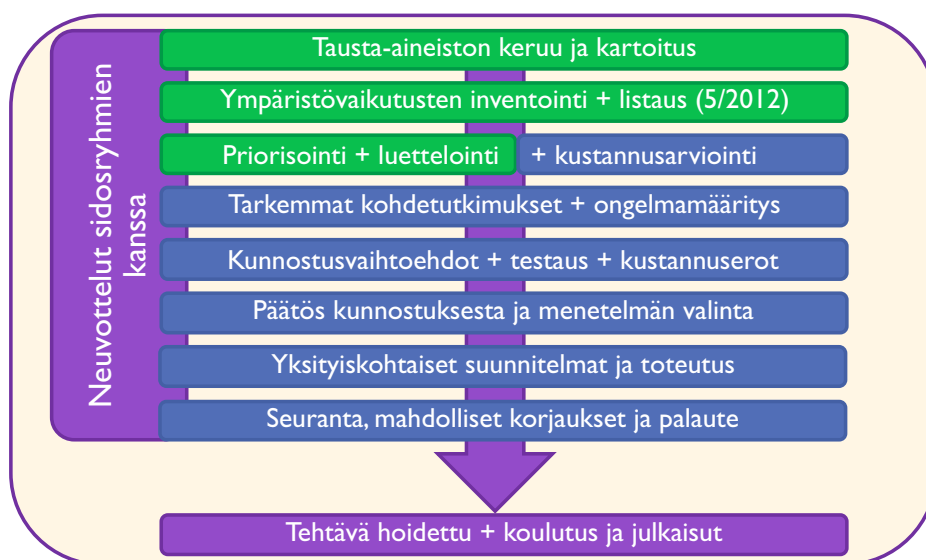
Kuva 63. Kaaviokuva pohjautuu Euroopan komission ehdotukseen suljettujen ja hylättyjen kaivannaisjätealueiden kunnostusstrategiasta (Mukaiutu: DHI 2012). Suomessa KAJAK I- ja KAJAK II-hankkeissa tehty työ on esitetty kaaviossa vihreällä.
