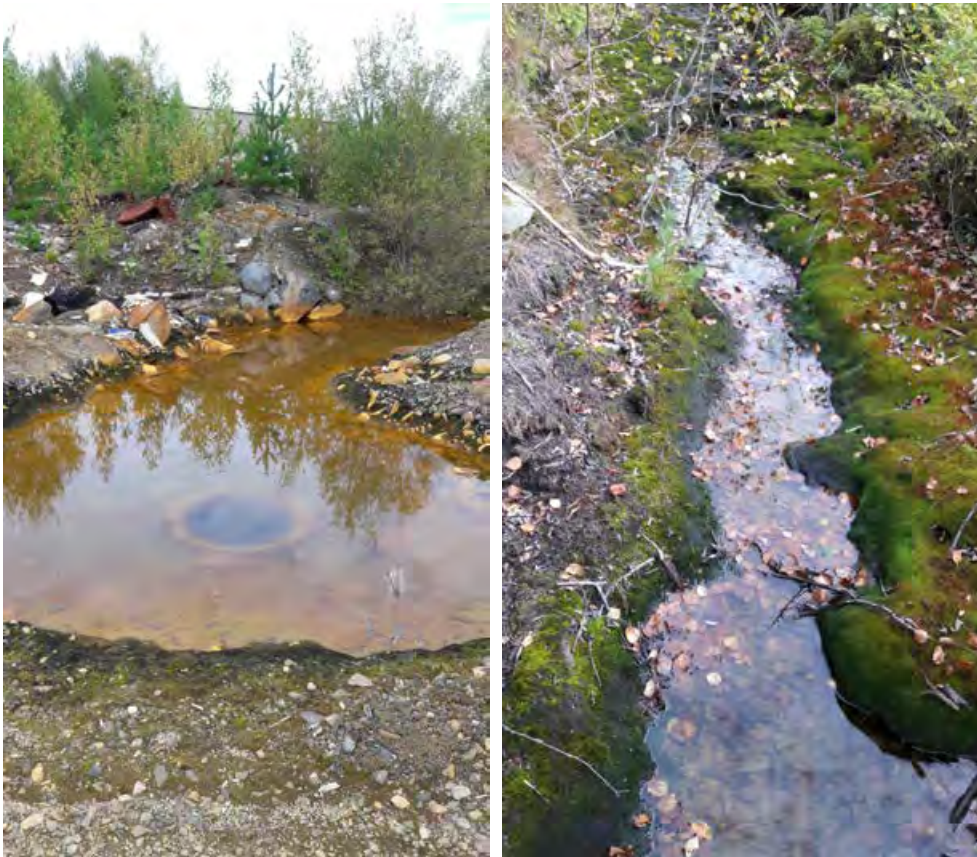
Kuva 13. Hällinmäen suljetun kaivoksen eteläpuolisista pintavesistä mitattiin alhaisia pH-lukemia maastotarkastuksen yhteydessä elokuussa 2016. Vasemmassa kuvassa yksi rikastamon eteläpuolisen alueen vesilammikoista (pH 3,24) sekä oikeassa kuvassa entiseltä malminvarastointialueelta Salajokeen virtaava puro (pH 4,28), Pieksämäki, Etelä-Savo. (© A. Tornivaara, GTK)
